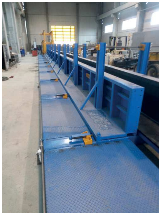
Linea di produzione dell'elemento precompresso con fianchi laterali per travi rettangolari.
