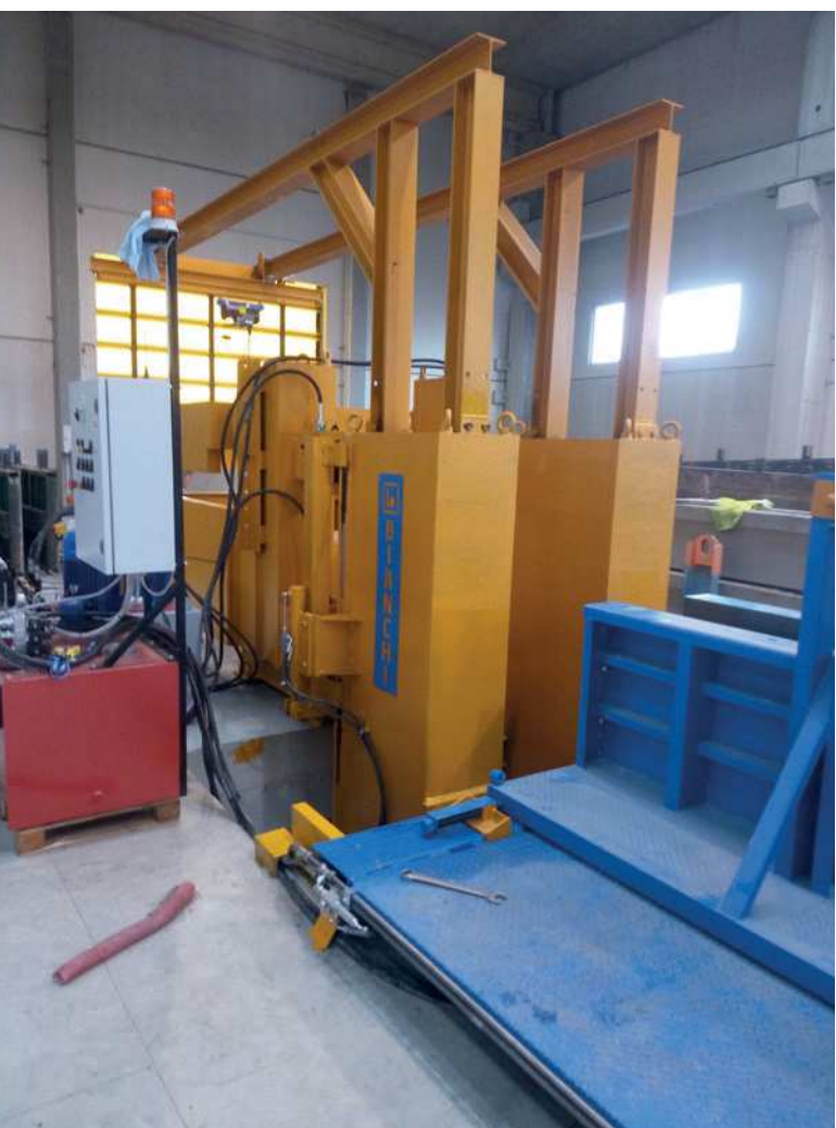
Testa della spalla di ancoraggio con unità idraulica
