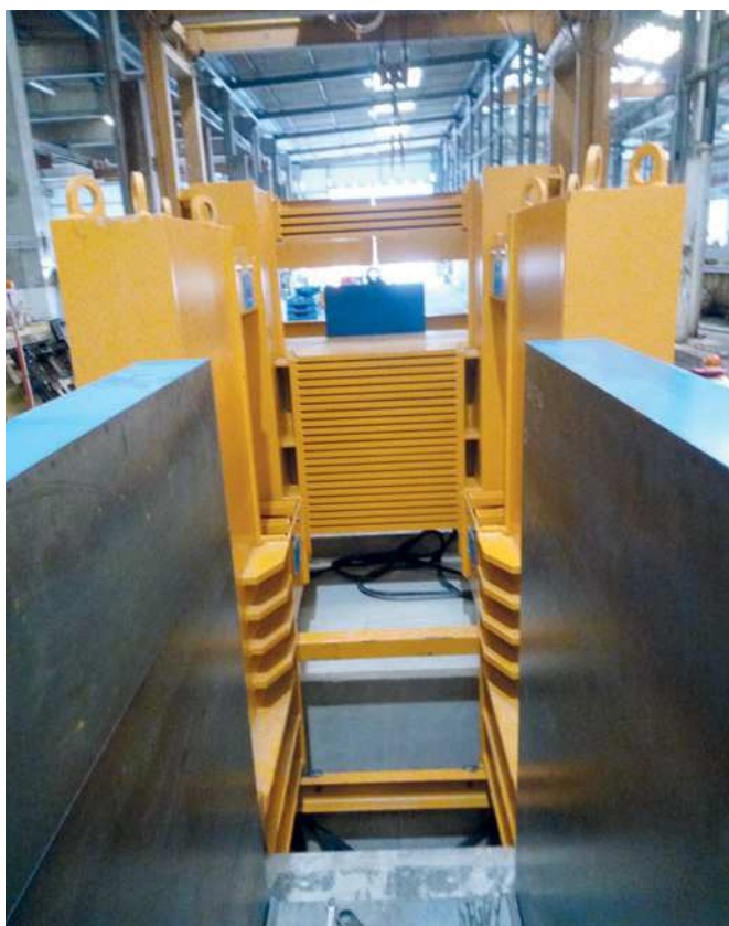
Vista della testate di ancoraggio trefoli
