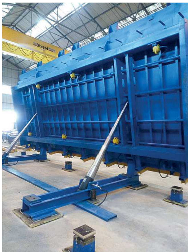
Banco Basculante Bianchi con dettaglio del sistema di vibrazione e maturazione
