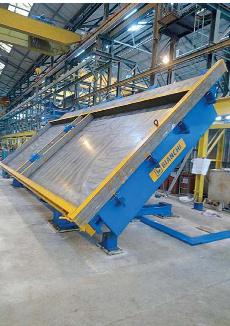
Banco Basculante Bianchi con dettaglio della lamiera di manto levigata e delle sponde/separatori magnetici montati
