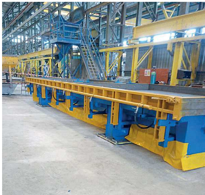
Banco Basculante Bianchi con dettaglio delle sponde longitudinale e trasversale
