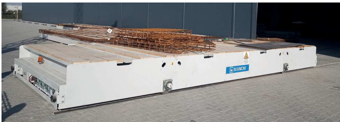
Carrello a batteria per lo spostamento dei pannelli nell'area di stoccaggio esterno.
