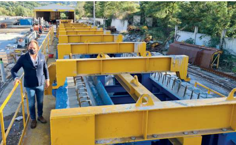
Форма на этапе бетонирования. Слева – Стефано Бьянки (Stefano Bianchi) из Bianchi Casseforme S.r.l.
