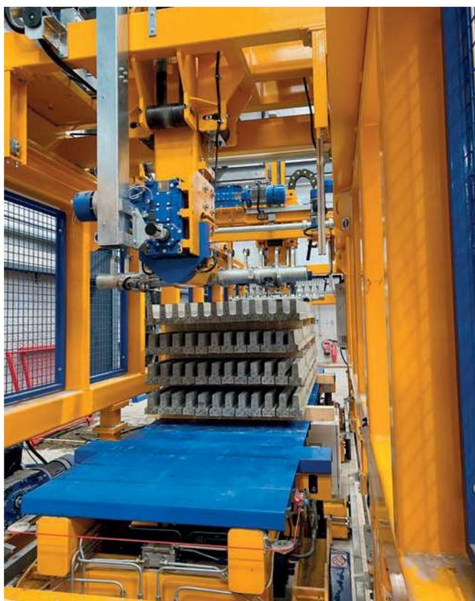
Dispositivo de volteo y de apilado en funcionamiento
