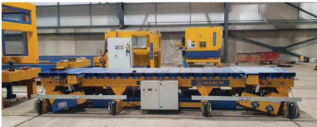
*Máquina multiusos de limpieza, desencofrado y transporte*
