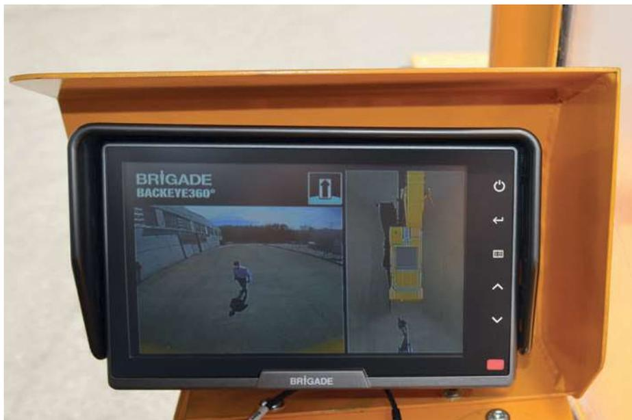
*Backeye®360 è, invece, il sistema di visione a 360 gradi tutto intorno al mezzo che, tramite un apposito software, riunisce e rielabora le riprese di quattro telecamere ultragrandangolari in una sola immagine, riproducendola immediatamente sul monitor in cabina.*
