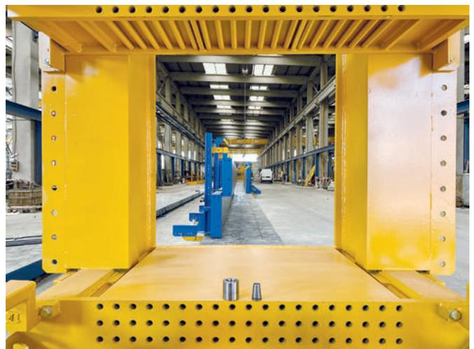
*Vista a través de la base del cabezal de pretensado (68 m) y encofrados laterales para vigas en T, en L y rectangulares*
