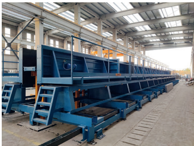
Moule de poteau réglable d'une longueur de 32 m
