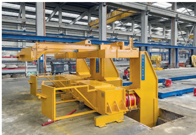
Butées fixes de relaxation d'une capacité de 800 tonnes chacune
