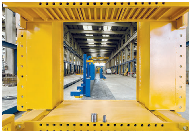
Vue à travers la base de la tête de précontrainte (68 m) et les moules latéraux pour poutres en T, en L et rectangulaires
