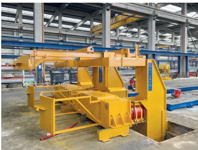
Blok oporowy o nośności 800 t.
