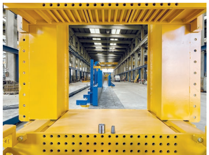
Widok przez głowicę bloku oporowego (68 m) na szalunki boczne dla dźwigarów o przekroju w kształcie litery „T”, „L” i prostokątnym.
