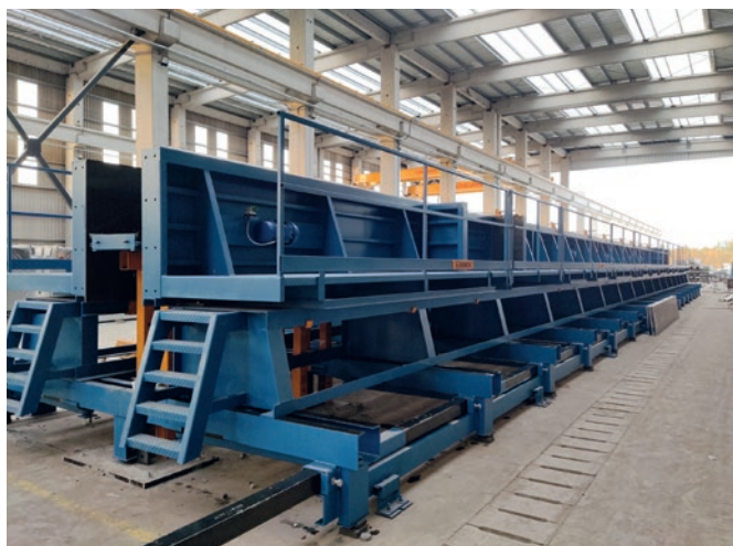
Regulowana forma do produkcji słupów o długości 32 m.
