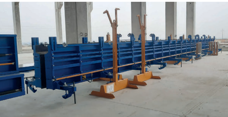
Encofrados laterales para vigas en T
