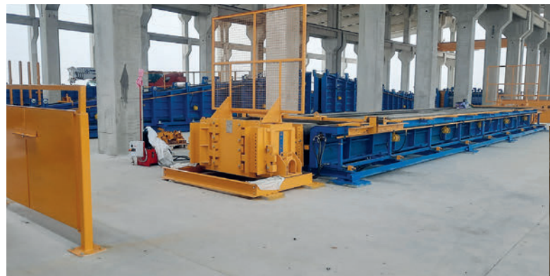
Encofrado de autorreacción para placas de doble T
