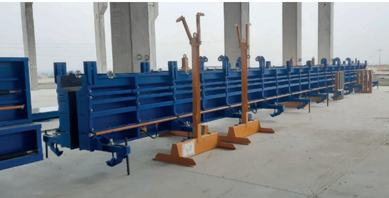
Boczne tarcze formy do belek teowych.
