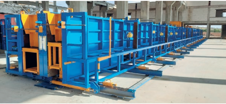
Dwuelementowa forma bateryjna do słupów.
