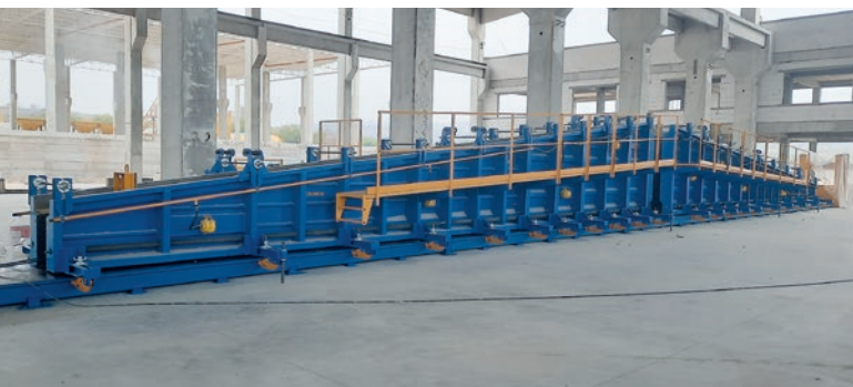
Boczne ściany formy do belek dwuspadowych.
