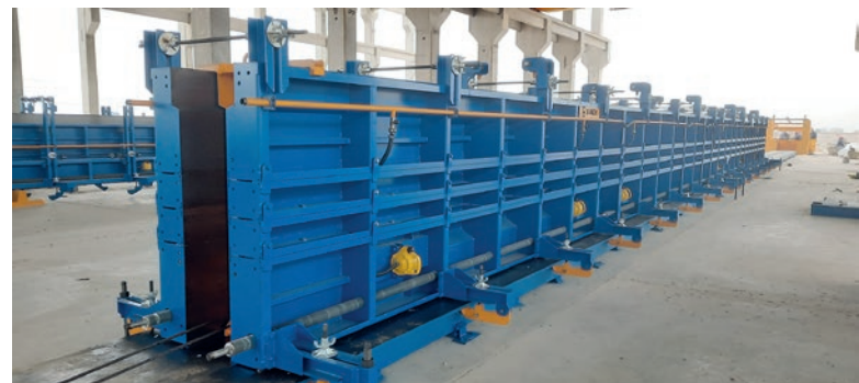
Boczne tarcze formy do belek dwuteowych.
