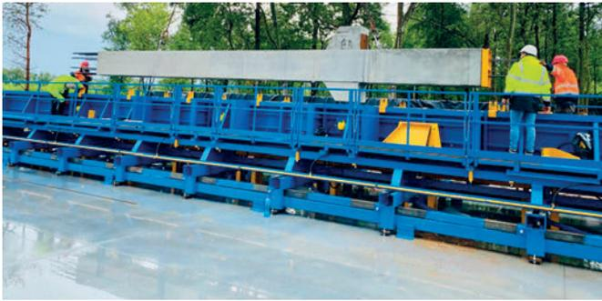
*Pilar prefabricado de hormigón*
