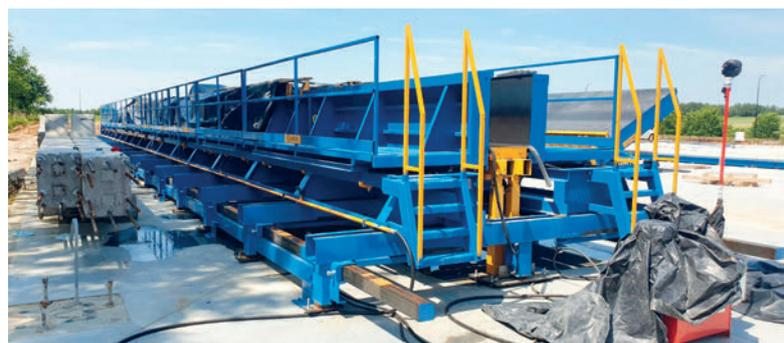
Encofrado de pilares hidráulico
