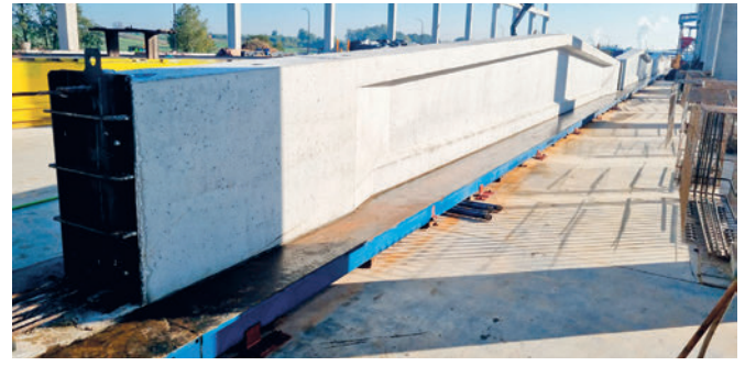
Poutres à double pente
