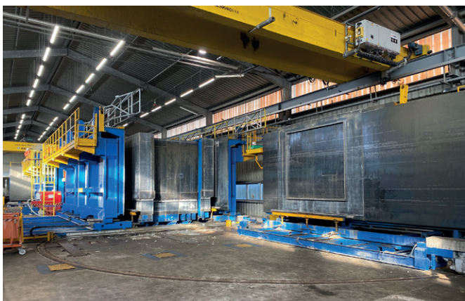
采用预制容积式建筑技术生产的自立式三维模块
