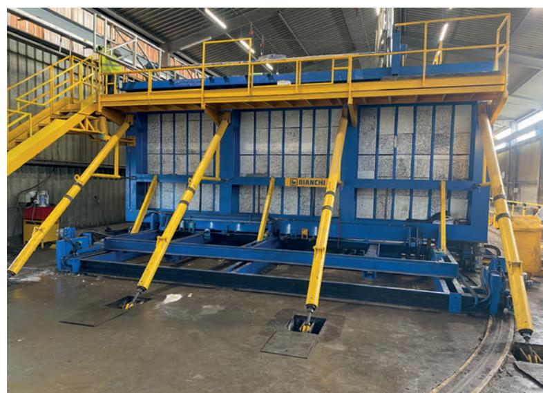
Production de modules tridimensionnels avec la technologie du PPVC
