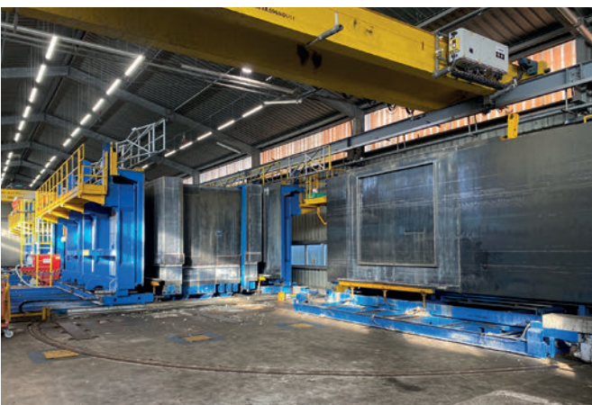
Produzione di moduli tridimensionali indipendenti con tecnologia PPVC
