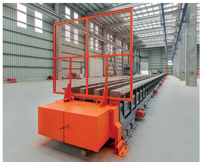
Encofrado para correas
