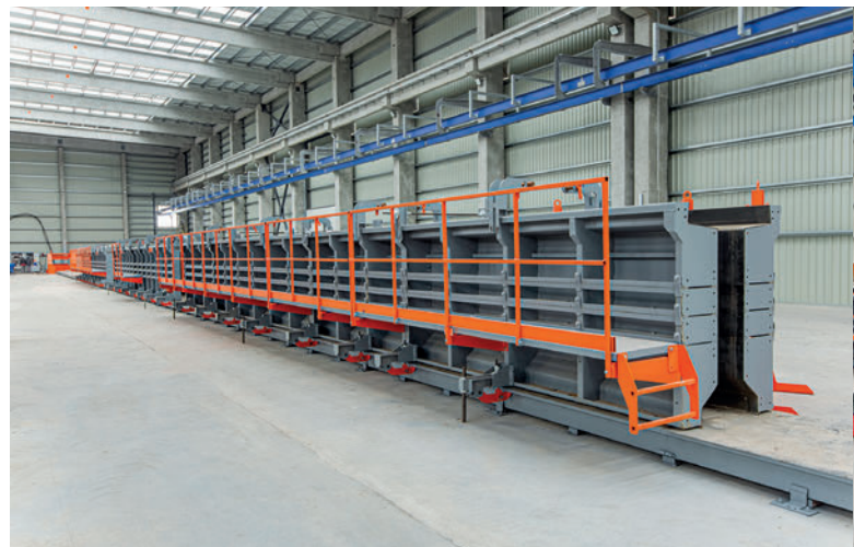
Encofrado para vigas tipo I
