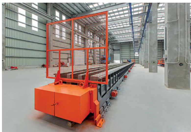
Cassero auto-reagente per travetti trapezoidali
