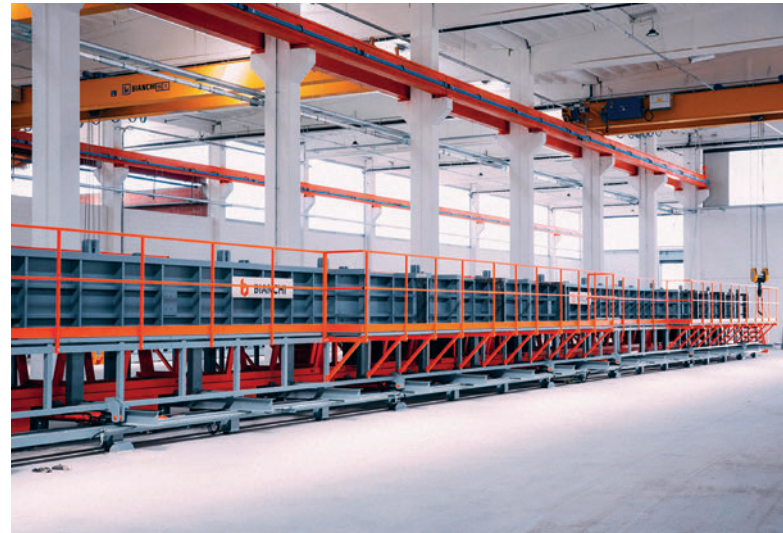
Encofrado de pilares de varias piezas
