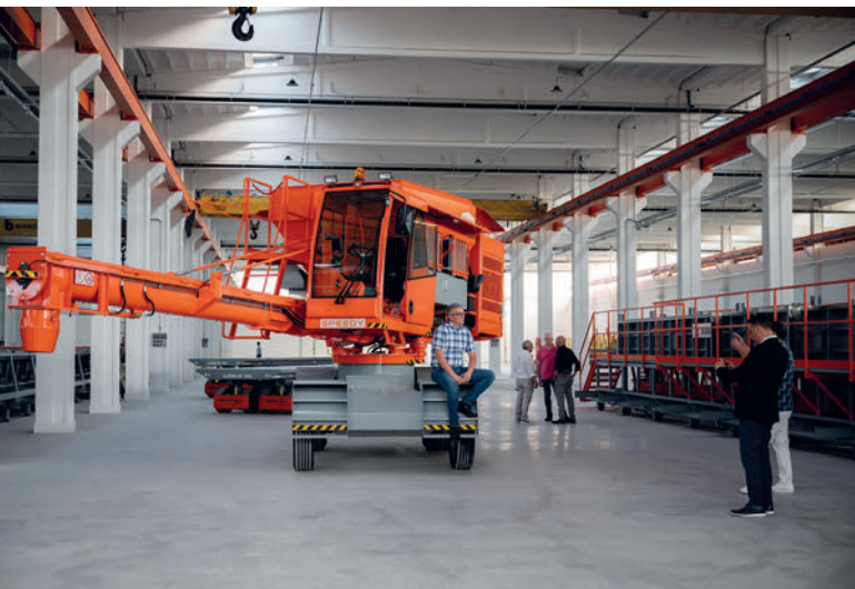
Speedy per distribuzione calcestruzzo
