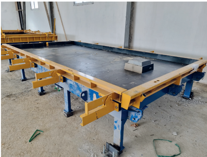
用于生产底板的固定工作台
