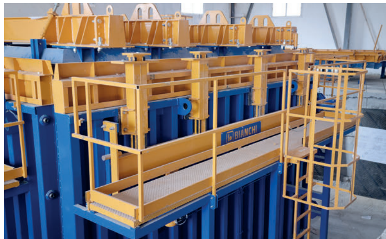
Encofrado con pasarelas y barandillas
