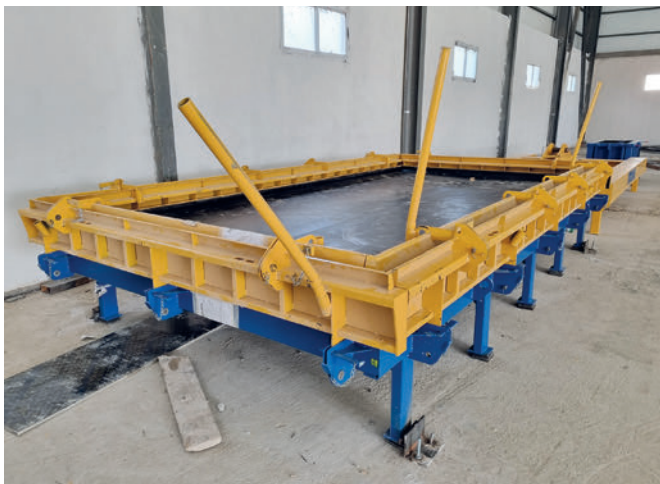
Mesa fija para la producción de tejados
