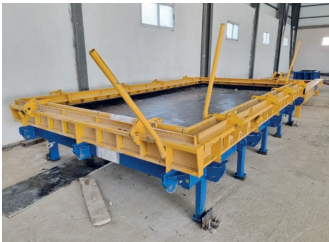
Stacjonarny stół do produkcji elementów dachowych.
