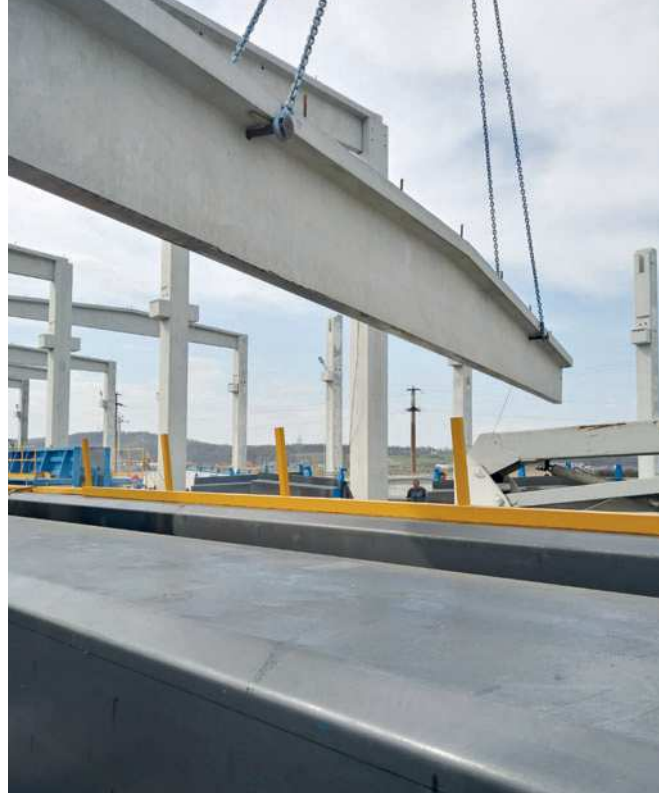
Scassero di una trave a doppia pendenza dalla pista idraulica
