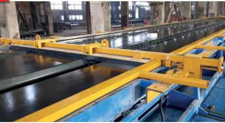
Coffrage TT prêt au coulage
