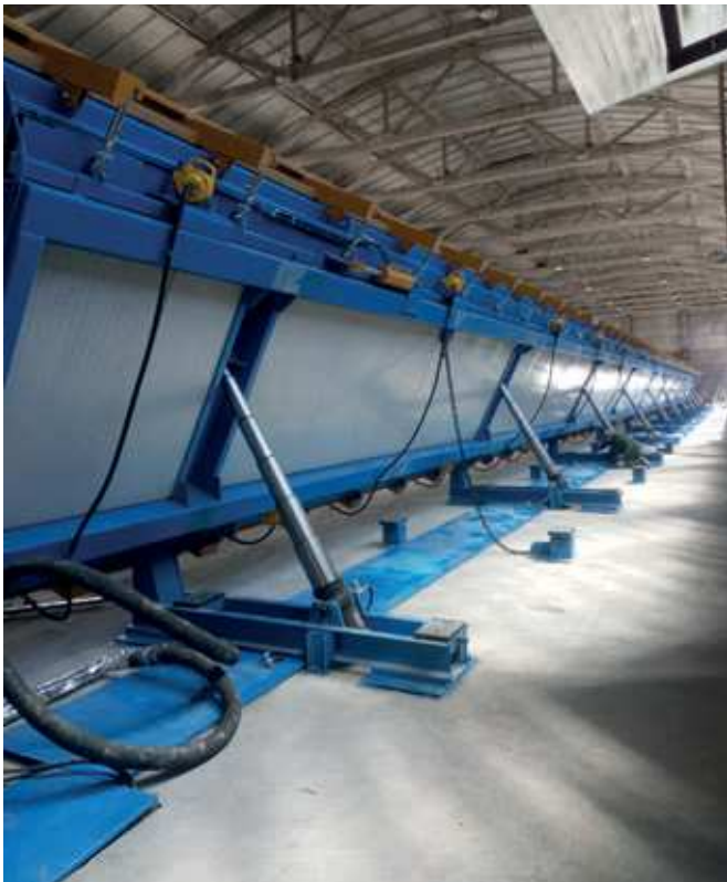
Vue arrière de la table basculante avec les vibrateurs
